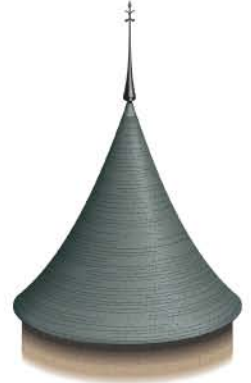
toit M en poivrière F conical broach roof cubierta F cónica Kegeldach N tetto M a cono M
